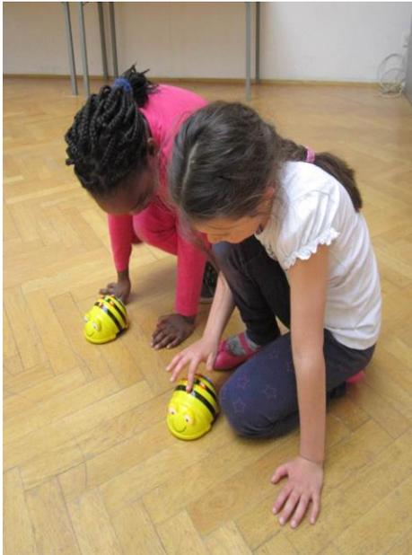
Die preisgekrönten Bodenroboter der britischen TTS Group zeichnen sich durch eine einfache und kindgerechte Gestaltung aus. Programmiert werden sie über die Tasten auf ihrem Rücken. Möglich sind Bewegungen in Einheiten von 15 cm nach vorne und zurück sowie Drehungen um jeweils 90 Grad nach links und rechts. Dadurch ergeben sich einfache Ablaufmuster ohne komplizierte Winkel.
